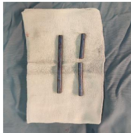
(Gambar 2. Rod sisi patah pada sisi kanan)
